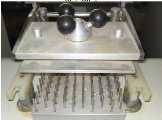
شکل ۱) دستگاه مورد استفاده در تحقیق حاضر جهت پر سازی پودر زنجبیل در درون کپسول
